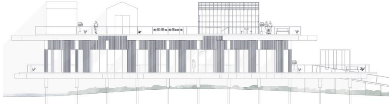
Opstalt, nedskaleret 1:50. Nye lag ligger i landskabet. Det strukturelle lag løfter det opakte lag, som skaber et nyt naturligt mødested. Derved kan regnvand fra det urbane landskab frit oversvømme det nye landskabslag.
