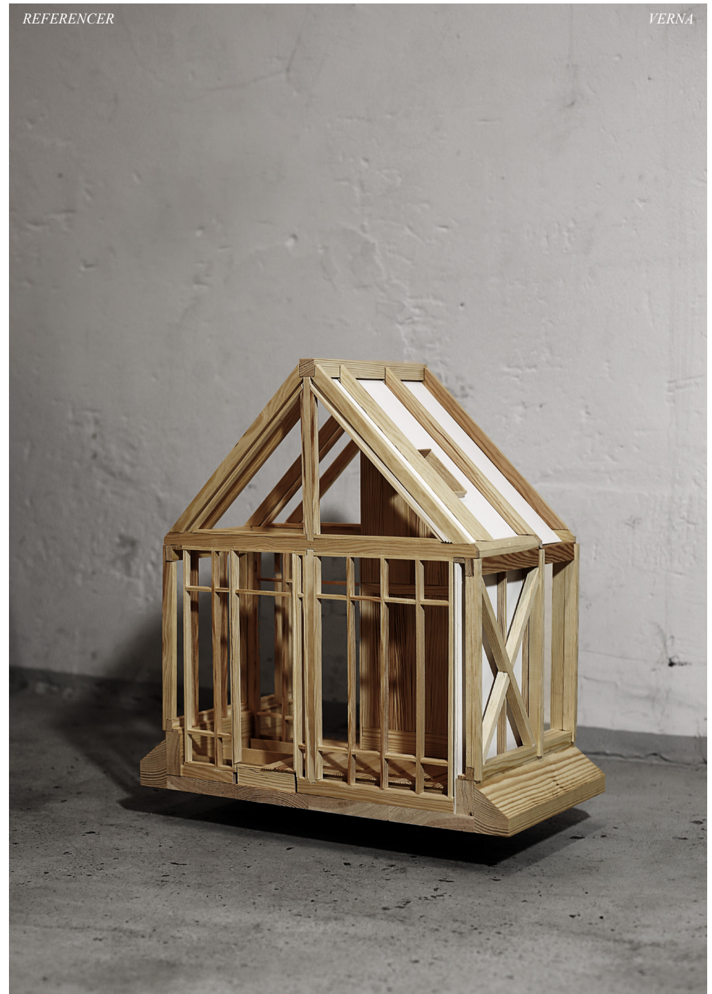
Konstruktionsmodel der viser et udsnit af bindingsværkshuset i 1:20
