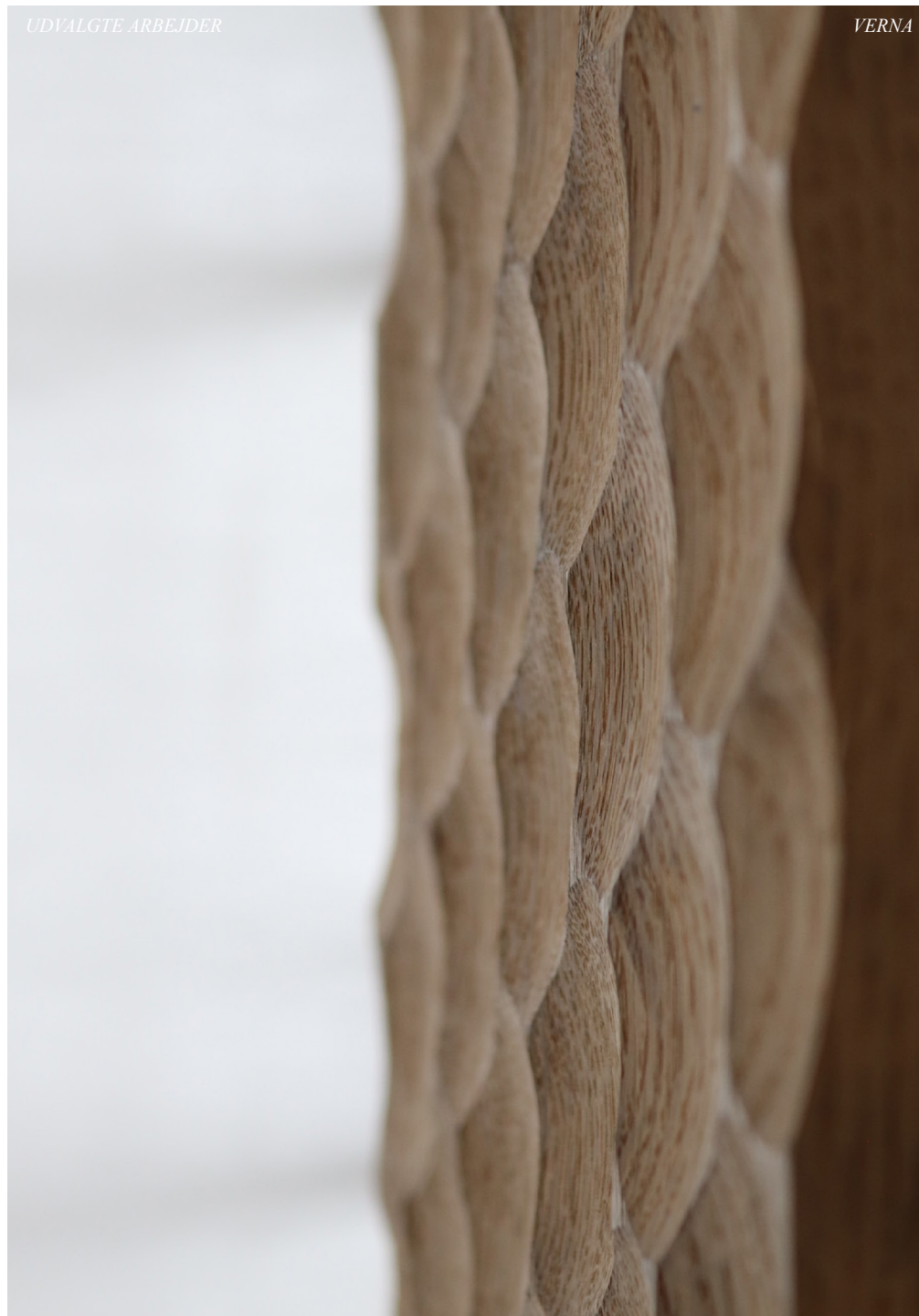
Snedkerprøve hvor vi har testet udskæringernes dybde, størrelse og mønstring
